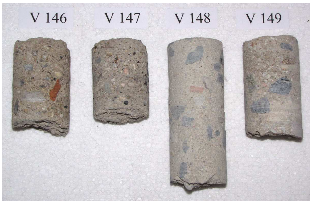
Obr. 1.: Vývrtý z betonu po dodání do laboratoře.
