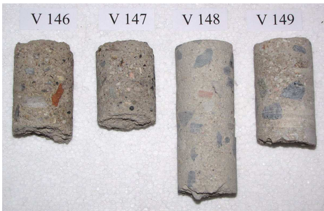
Obr. 1.: Vývrty z betonu po dodání do laboratoře.
